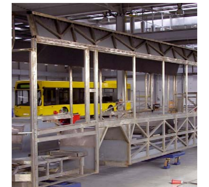
Scocca in acciaio INOX resistente alla corrosione
